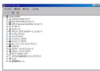
もし！や？マークのついたデバイスがありましたら、そのデバイスをダブルクリックしプロパティを開きます。プロパティの画面からドライバの更新を行い、ドライバの検索場所の指定にて、付属のドライバディスク等適切な場所を指定し、ドライバのセットアップを行ってください。
