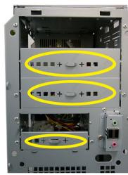
(2) 取り付けするドライブに応じてフロントパネルのカバー、本体側の金属のカバーを外します。本体側の金属カバーをゆっくり回すようにはずし、手を怪我しないよう十分ご注意ください。
