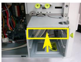
(3) 回転しましたら、ハードディスクドライブを差し込みます。差し込みましたら、元に戻します。
