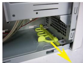
(1) フロントパネルを外すには、ケース内部に取り付けられたフロントパネル取り外しレバーを左写真の矢印の方向に引きます。自然にフロントパネルがはずれます。はずしましたら、レバーを元の位置に戻しておきます。
