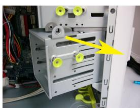
(2) そのままフレームを写真の矢印の方向に回転させてください。
