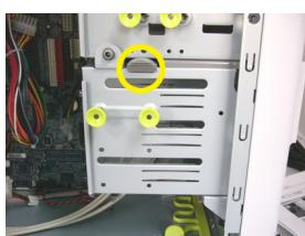
(1) ハードディスク取り付け用フレームは上部でクリップにより固定されていますので、そちらを上に持ち上げます。
