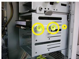
(4) ネジ穴とドライブのねじ穴があうように調整し、最上段は、固定ピンを押し込みドライブを固定します。2段目3段目はインチネジにて固定します。
