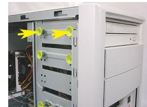
(3) 準備ができましたらフロントパネルを元のよう取り付けし、ドライブを本体前面から差し込みます。ドライブのねじ穴があうようにドライブをセットしてください。セットできましたら、固定ピンを押し込みドライブを固定します。(この2個の固定ピンのみでドライブの固定は可能ですが、ミリネジを使用し別途ネジ止めすることも可能です。)
