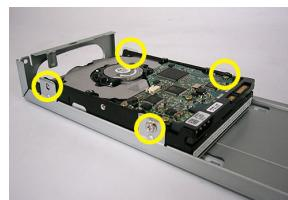
(4)はずしたパーツの背面に 3.5 インチハードディスクを搭載するスペースがあります。写真丸印 4箇所をネジ止めしてハードディスクを固定します。
