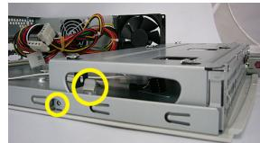
(1) 写真の位置にありますネジを外した後、そばにある爪をはずします。(左右両方あります)
