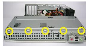
(5) パーツを元に戻すときは、まずケース前方の写真丸印 5箇所に爪を引っかけてから、パーツを寝かせて元のように戻します。
